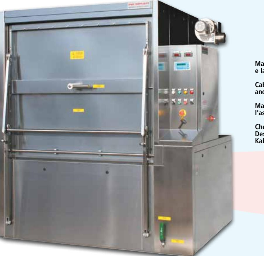
Macchina a cabina, per il lavaggio e la sanificazione chimica.
