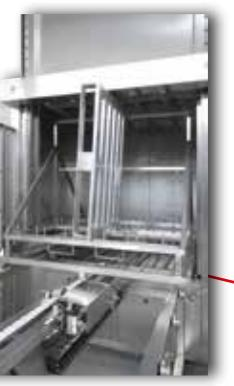
Macchina a cabina con carico e scarico automatico
